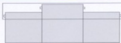
Podwójna kasetta kurtyny z wałami na różnych wysokościach. Szerokość 150 mm x wysokość 250 mm.
